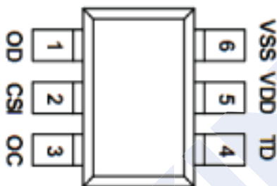
图 3 KP00Q05的 SOT23-6 封装及引脚排布
